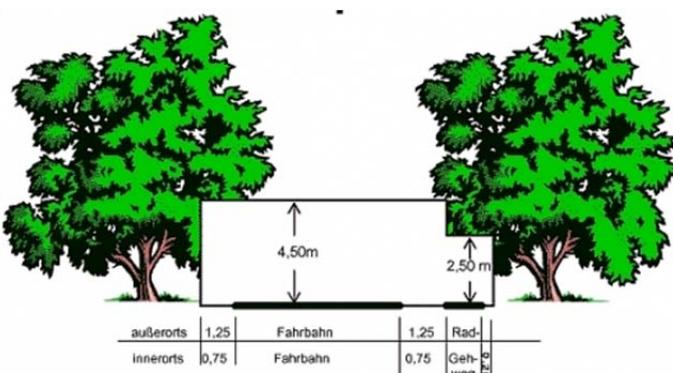
4,50 m für den Kraftfahrzeugverkehr über der gesamten Fahrbahn. Der Verkehrsraum ist die befestigte Fahrbahnbreite plus beidseitig mind. 50 cm Sicherheitsfläche.
